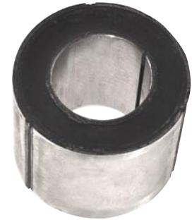
Le bussole a settore si utilizzano per aumentare la precompressione della gomma rispetto alle tradizionali bussole. È ammesso un angolo torsionale massimo di  $\pm 7,5^\circ$ .
