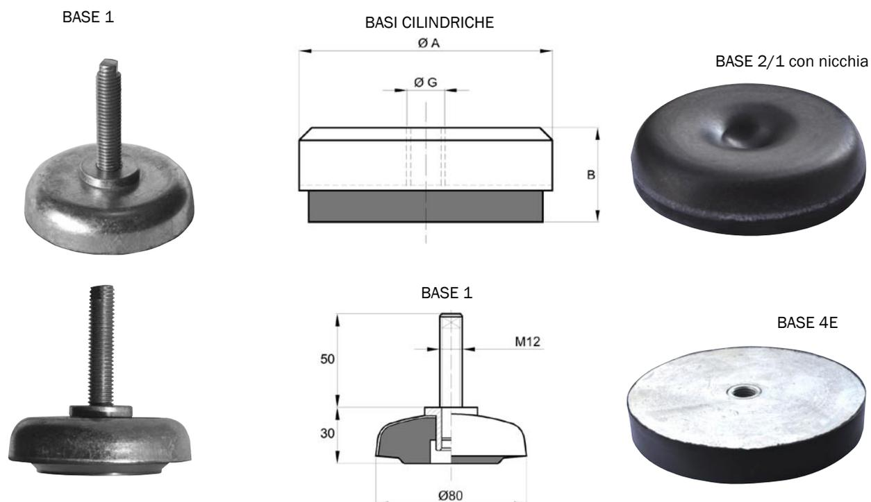
Le basi antivibranti sono costituite da un coperchio metallico e dalla base in gomma. Servono ad ammortizzare macchine con grossa massa tipo presse, macchine utensili, gruppi compressori, ecc.
