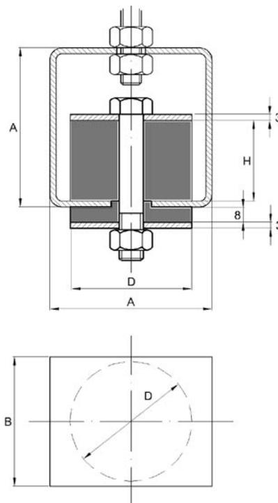
Studiati per sopportare carichi sospesi come controsoffittature, tubazioni di condutture aeree per fluidi, gas e negli impianti di condizionamento.
